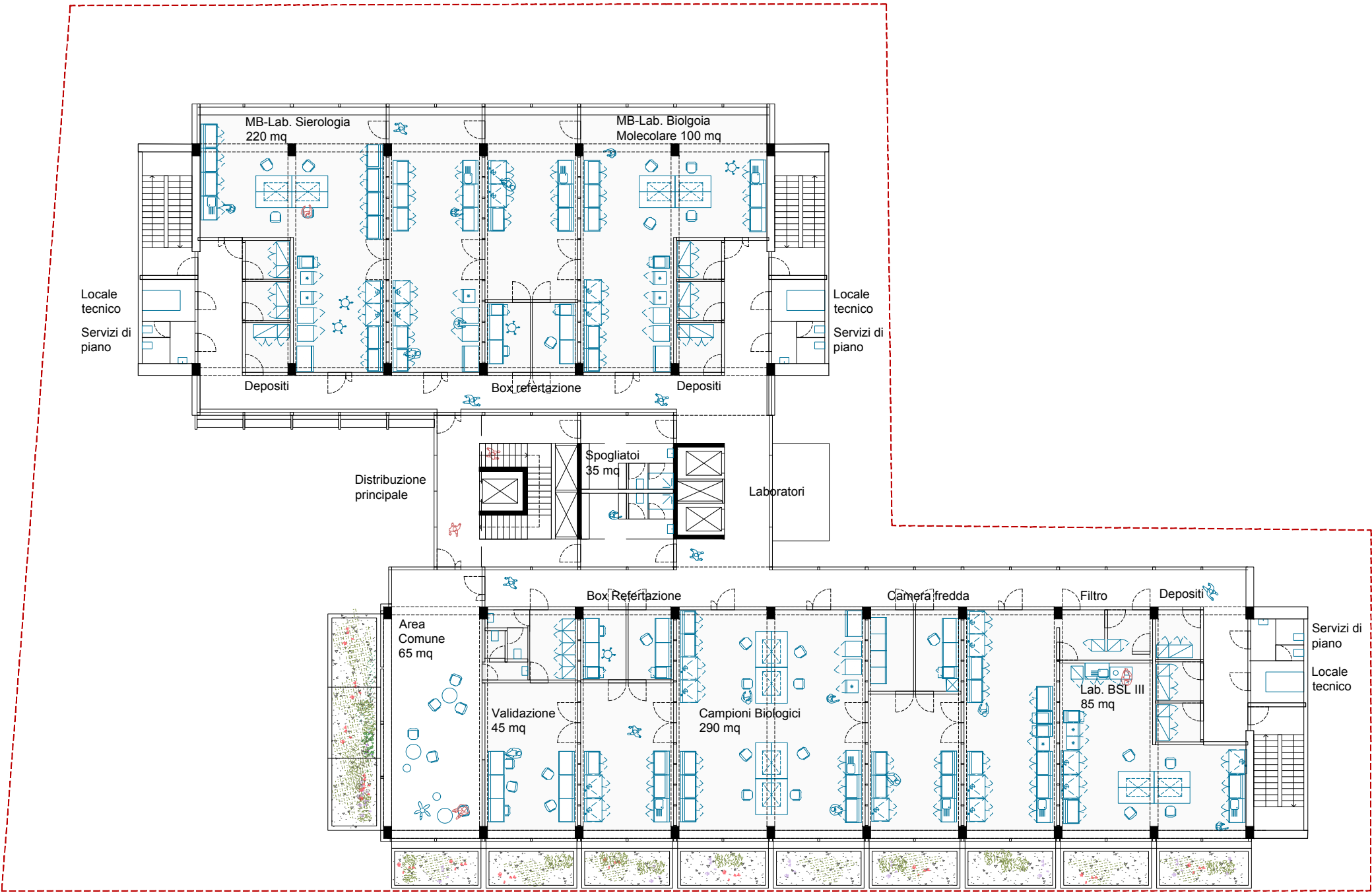
PIANTA PRIMO PIANO LABORATORI SCALA 1:250
