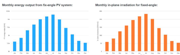
Fotovoltaico in copertura: Istogrammi Output pannelli fotovoltaici e Irradiazione solare
