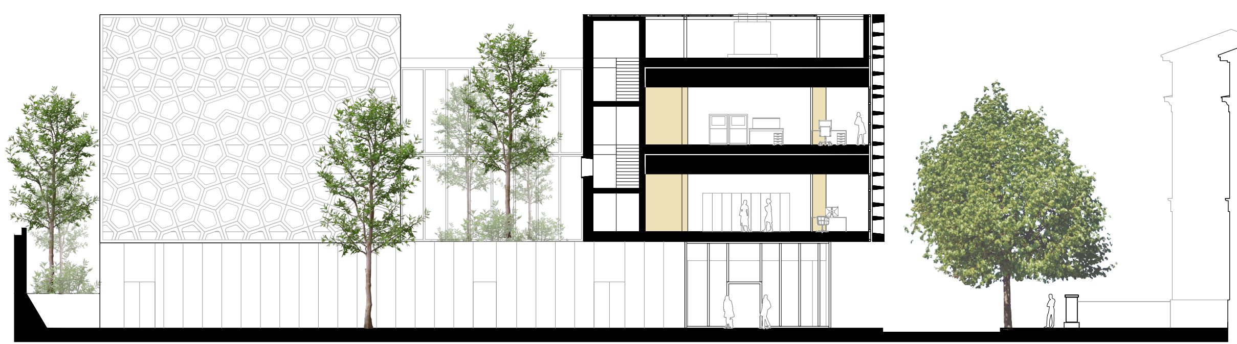
SEZIONE TRASVERSALE 2 e PROSPETTO OVEST scala 1/200
